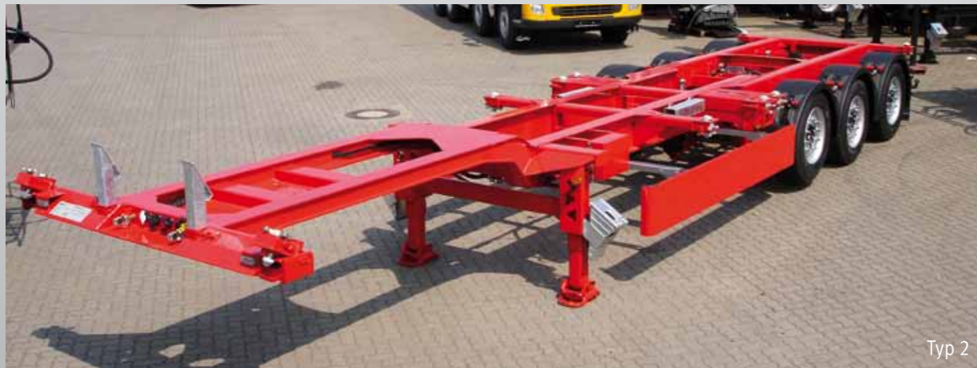
Containerchassis Typ CCS/HS mit Heckausschub
