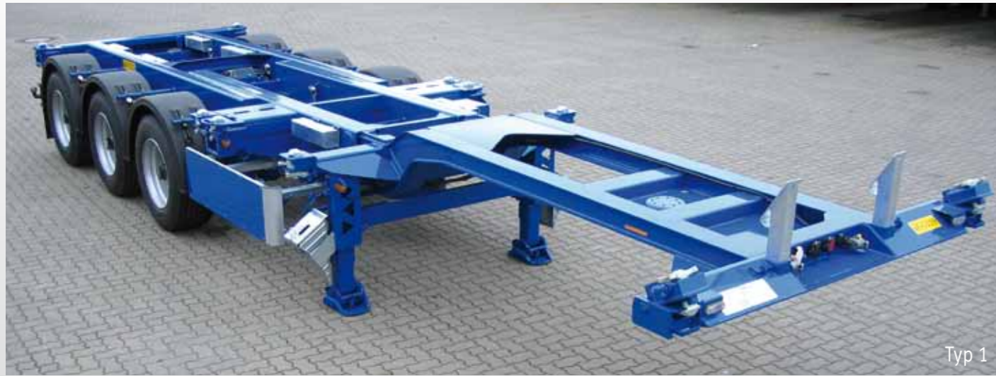
Containerchassis Typ CCS/MHS mit Mitten- und Heckausschub
