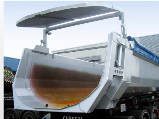
Hydr. Rückwand mit großer Durchlassöffnung
