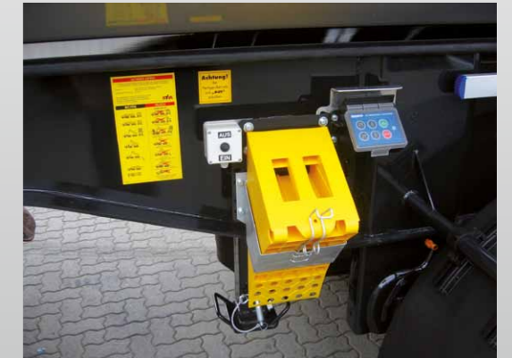
Ein-Aus-Schalter f. Kipperabsenkung Funktionschalter Heben u. Senken
