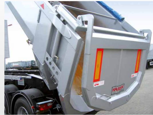
Abschaltbare hydr. Rückwand als Pendelklappe
